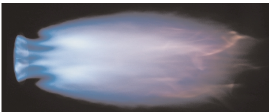
Рисунок пламени при пониженном содержании \text{NO}_x
